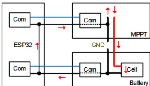
Und weil die Ströme zwischen Charger und Batterie sehr hoch sein können, wird mit ziemlicher Sicherheit irgendein Element (Kabel, Stecker, Leiterbahn) in diesem parallelen Masse-Zweig zerstört und kann auch einen Brand verursachen.
