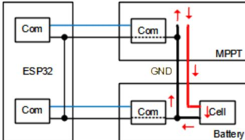
Wenn jetzt aus irgendwelchen Gründen, die starke Masse-Verbindung zwischen Charger und Batterie unterbrochen wird, dann fließt der gesamte Rückstrom über die seriellen Datenschnittstellen und die ESP32-PCB.
