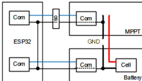
Kommt es jetzt zu einer Unterbrechung der Masse-Verbindung zwischen Charger und Batterie dann passiert nichts, weil es keine parallele Masse-Verbindung über die ESP32-PCB gibt. Die galvanisch getrennte Datenschnittstelle unterbricht die parallele Masse-Verbindung zwischen Charger und Batterie.
