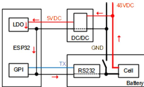
Ok, der Rückstrom fließt wieder über die Masse-Verbindung der RS232 Schnittstelle. Aber ist das auch gefährlich? Um das zu beantworten, müssen wir ermitteln, wie hoch der Strom ist und ob die gesamte parallele Strecke inklusive Leiterbahnen im BMS und auf der ESP32-PCB den Strom sicher leiten können. Das wird in nahezu allen Installationen funktionieren, weil die Ströme klein sind, aber sicherlich nicht in allen.
